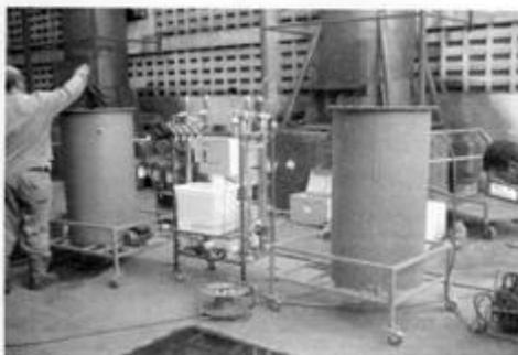
Gambar 5 : Instrumen peralatan reduksi emisi  $\text{CO}_2$  menggunakan teknologi absorpsi melalui membrane serat berpori.
